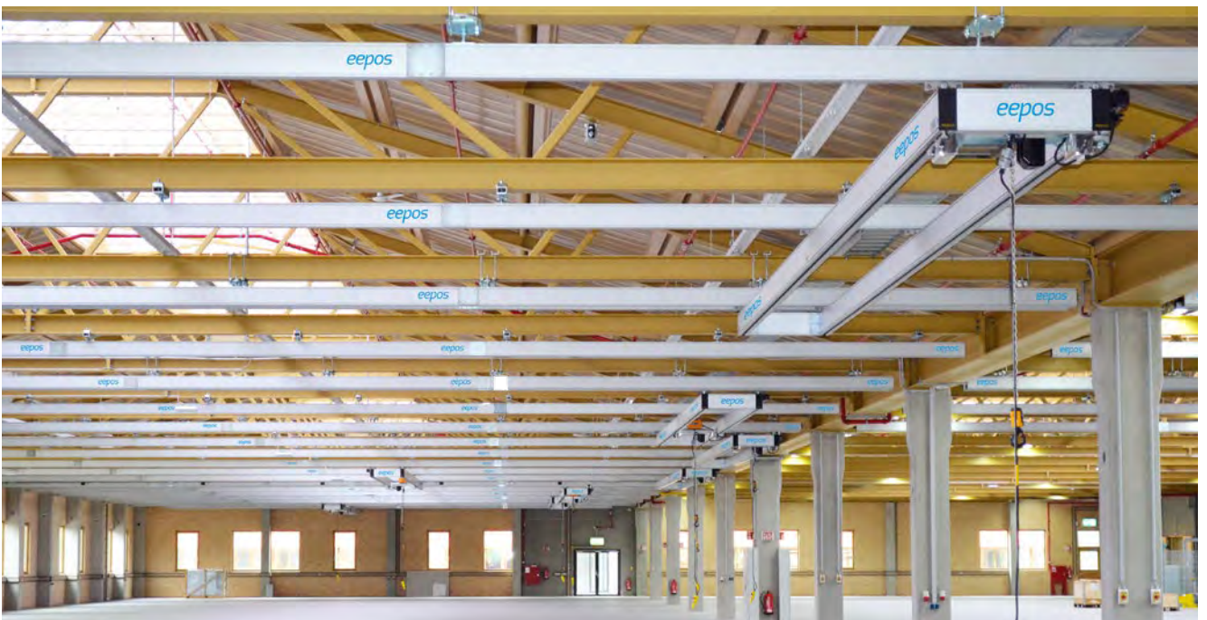
Bild unten: Produktionshalle mit Zweiträgerkranen Below: production plant with double girder cranes
