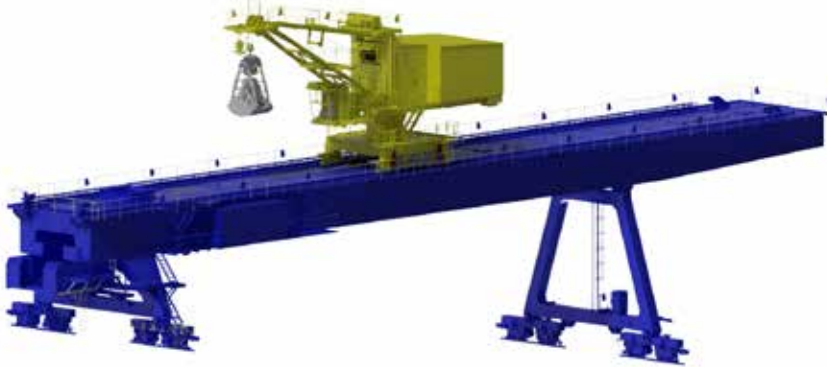
Jeřáb portálový drapákový 16t - 45m + 12,5m + 19,2m
