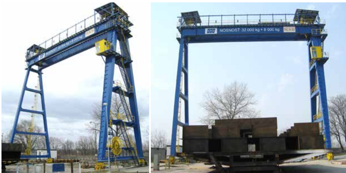
Jeřáb portálový 32t + 8t - 26,5m - Slovenské Loděnice Komárno, a.s.
