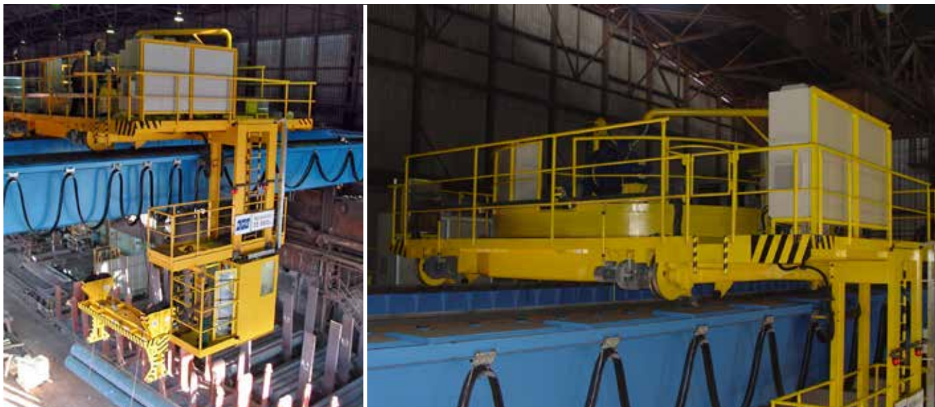
Jeřáb mostový 35t - 25m - U. S. Steel Košice, s.r.o.
