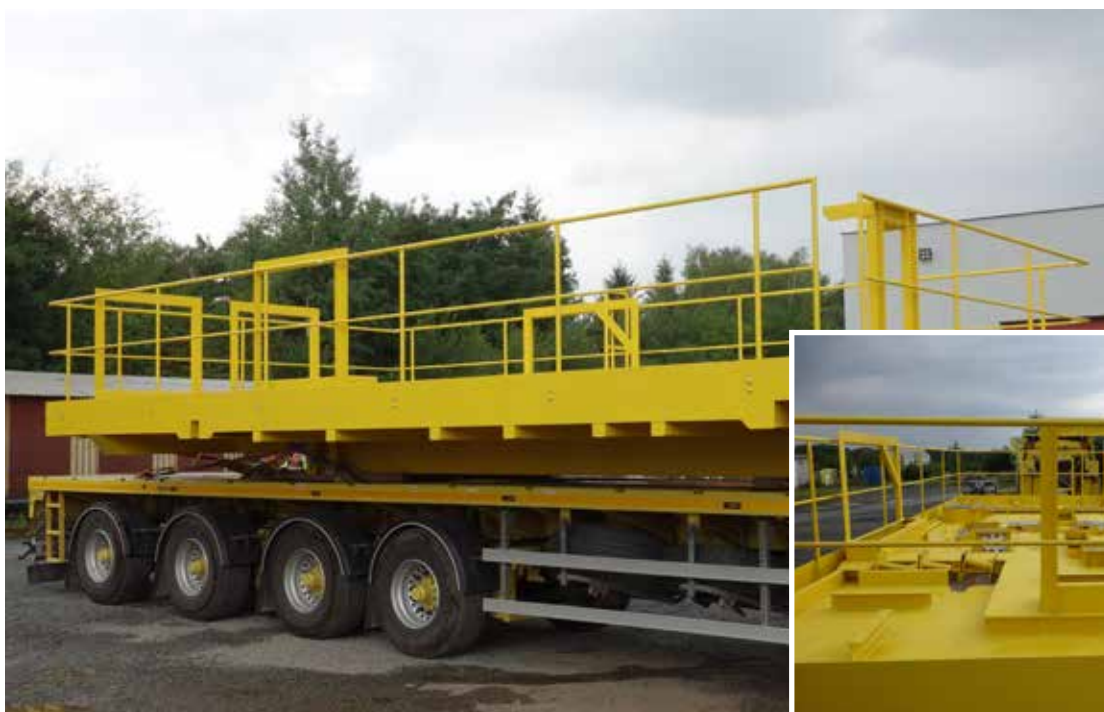
Rám kočky magnetodrapákového jeřábu 12,5t/12,5t - U. S. Steel Košice, s.r.o.
