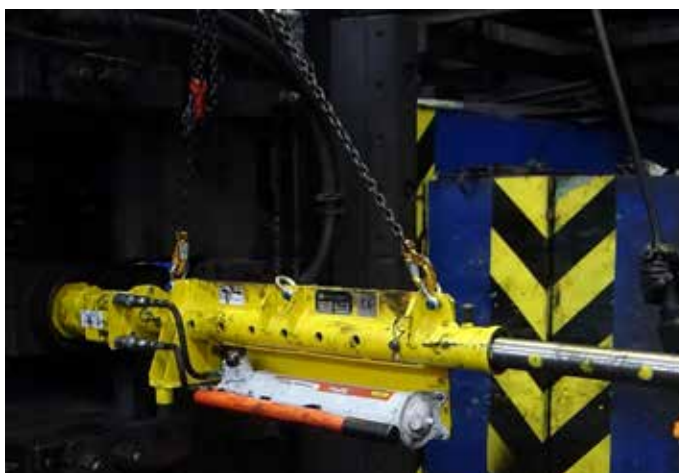
Manipulátor na manipulaci s vběhovými skříněmi - ArcelorMittal Ostrava a.s.
