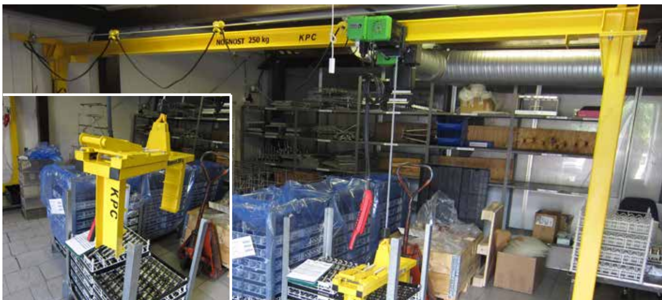
Jeřáb portálový 250kg - 4,7m - VHM Plasma, spol. s r.o.
