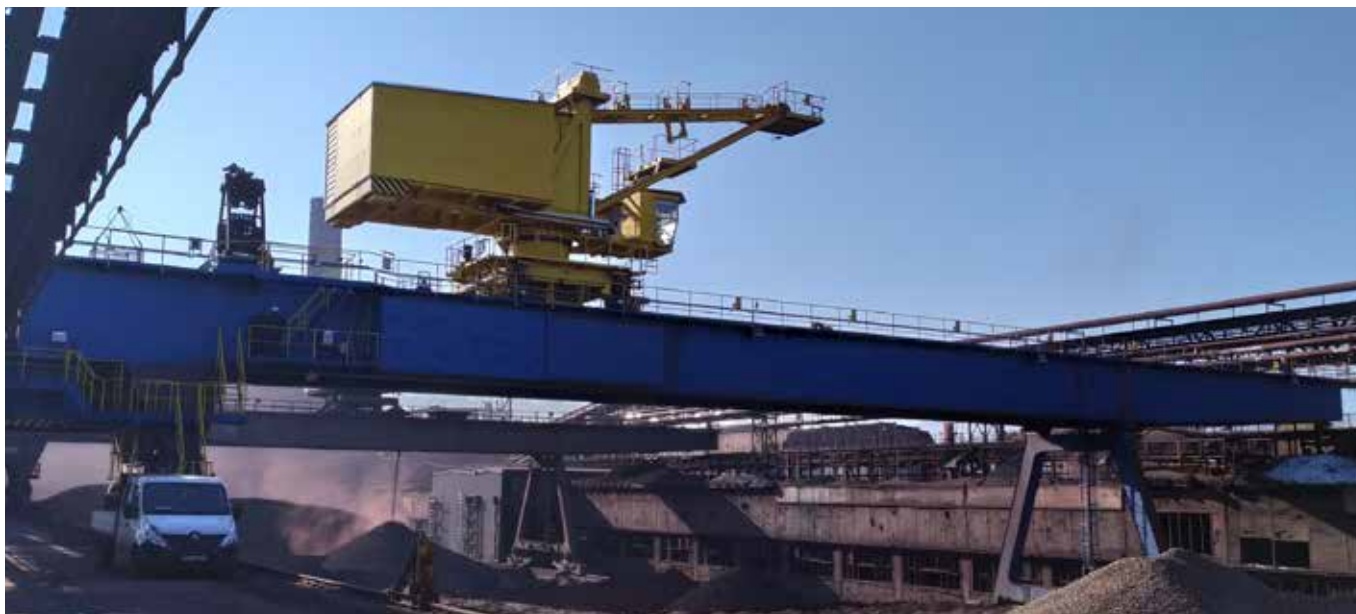
Jeřáb portálový drapákový 16t - 45m + 12,5m + 19,2m - Strojírny Třinec a.s.
